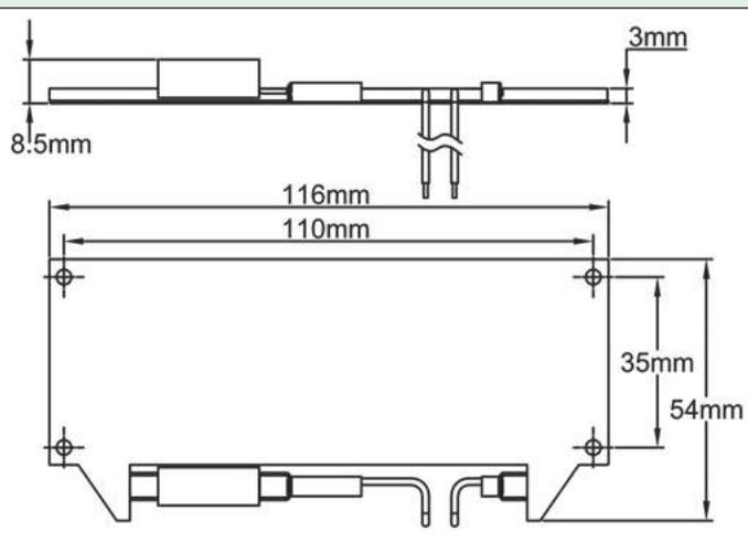
Situé immédiatement sous le niveau du hublot transparent, la circulation d'air chaud qu'il provoque évite l'apparition de condensation sur le hublot et conserve une température ambiante dans le boîtier optimale pour les organes de contrôle.
