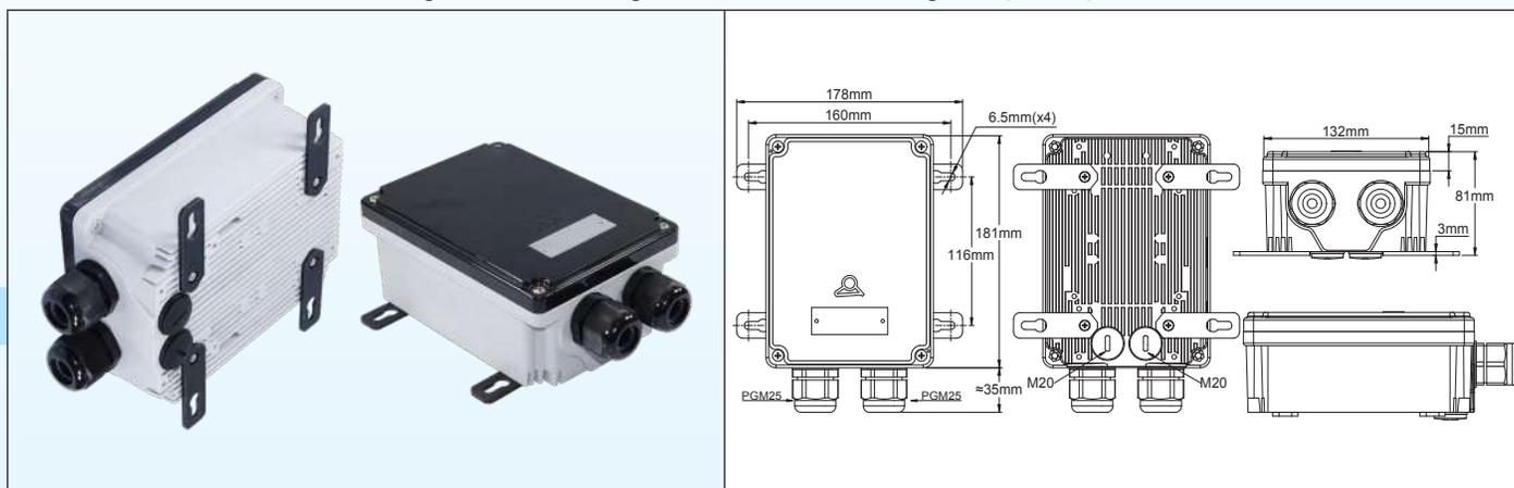
Ces boîtiers étanches en aluminium avec peinture époxy RAL 7015. Ils ont les mêmes dimensions que les boîtiers de commande en plastique et utilisent des couvercles plats. Ils utilisent les mêmes pattes de fixation murales que les modèles en plastique. Ils ont été conçus pour le montage de relais statiques monophasés ou triphasés dont le refroidissement est assuré par les ailettes en face arrière.
