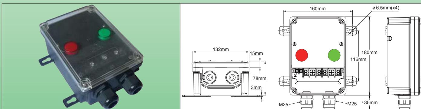
Bornier de raccordement 2 x 2.5mm<sup>2</sup> et 6 x 10mm<sup>2</sup> avec contacteur 3 x 25A (AC1), 250V. Voyant rouge de présence de tension et voyant vert de sortie (250V). Couvercle transparent.
