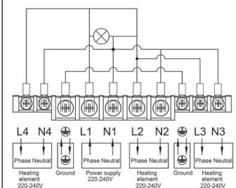
**Câblage:** alimentation de puissance Neutre + Phase + Terre sur un bornier 6mm<sup>2</sup>, et sortie vers 3 circuits de chauffage en 1.5 ou 2.5mm<sup>2</sup>.
