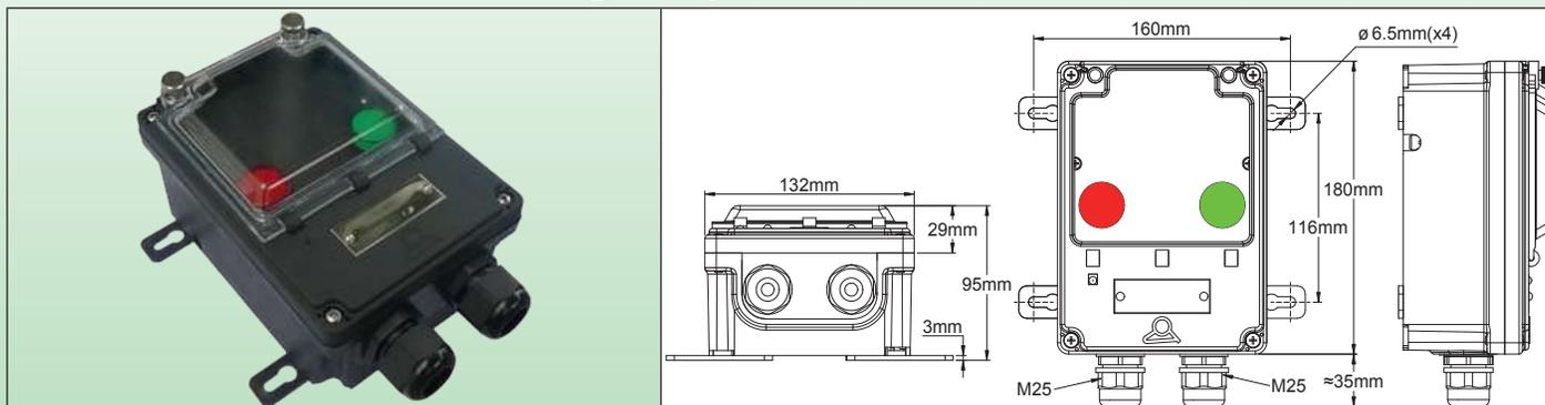
3 x 16A (AC1), 250V, bornier 5 bornes à vis 2.5 mm<sup>2</sup> et 5 bornes à vis 6 mm<sup>2</sup>. Voyant rouge de mise sous tension et voyant vert de sortie (250V), couvercle transparent.
