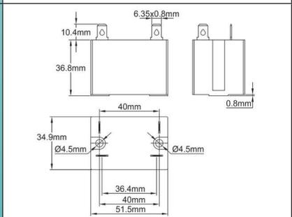
1 × 30A 250V résistif (AC1) (CE et UL) contact NO, Boitier étanche, languettes 6.35 × 0.8. Ce contacteur peut se monter directement sans platine de montage sur toutes les faces avant plastique décalées prévues pour les thermostats à bulbe et capillaire et régulateurs électroniques, ainsi que sur les face avant plates des coffrets de distribution de ce catalogue. Bobine 200-240V alternatif
