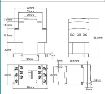
3 × 25A ou 3 × 32A 250/400V résistif (AC1), bornes à vis, bobine 240V ou 400V alternatif.
