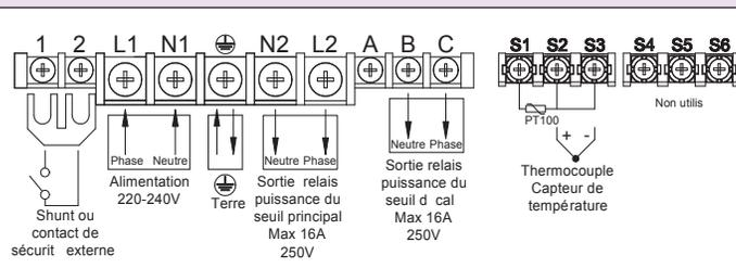
**Circuits triphasés, deux seuils en cascade, deux sortie relais 3 × 16A**
