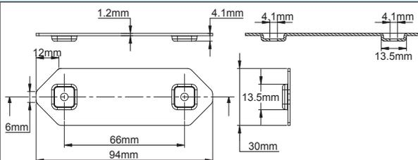
Permet l'assemblage côte à côte d'un boîtier équipé de ventilateur avec capot de protection avec un autre modèle de boîtier de mêmes dimensions
