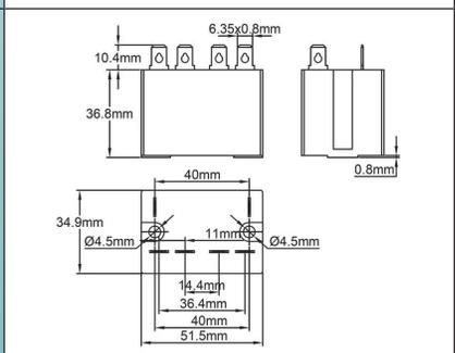
2 × 25A 250V résistif (AC1) (CE et UL) contact NO, Boitier étanche, languettes 6.35 × 0.8. Ce contacteur peut se monter directement sans platine de montage sur toutes les faces avant plastique décalées prévues pour les thermostats à bulbe et capillaire et régulateurs électroniques, ainsi que sur les face avant plates des coffrets de distribution de ce catalogue. Bobine 200-240V alternative.
