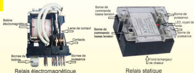
**Le relais ou contacteur électromécanique :** La bobine est constituée d'un très grand nombre de spires d'un fil de cuivre très fin. Quand cette bobine est parcourue par un courant suffisant, elle produit un champ magnétique qui attire la partie mobile et déplace les lames souples munies de contacts électriques. Quand plus aucun courant ne circule dans la bobine, les contacts reprennent leur position de repos grâce à un ressort de rappel.
